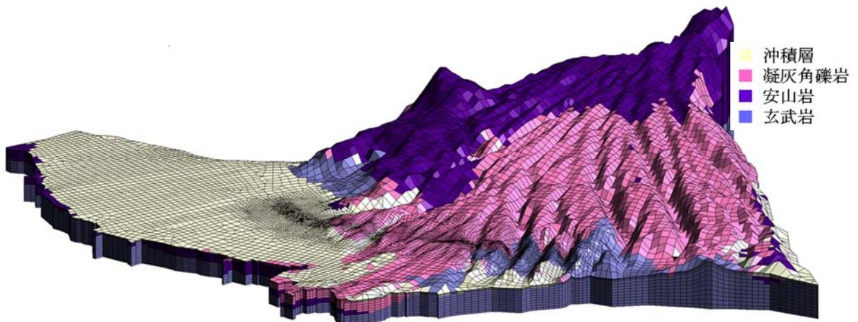
地質モデルを反映した3次元浸透流解析モデルの例\*
