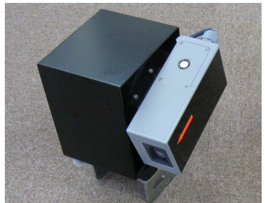
トンネル断面計測器（回転型レーザ距離計）
